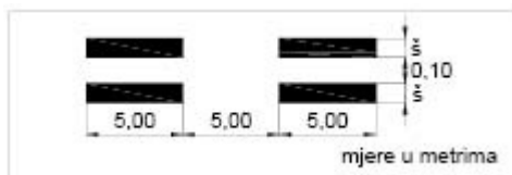
Slika 10. Izvođenje i mjere dvostruke isprekidane uzdužne crte
